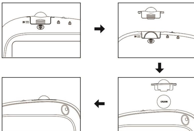
**Sostituzione della batteria:** rimuovere la vite di sicurezza ed estrarre il portabatteria, rimuovere la batteria, inserire una nuova batteria a bottone CR 2016 [3V] e reinserire il portabatteria nello slot.
